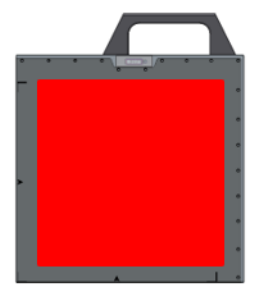
均匀荷载：探测器表面整体区域 20kg
